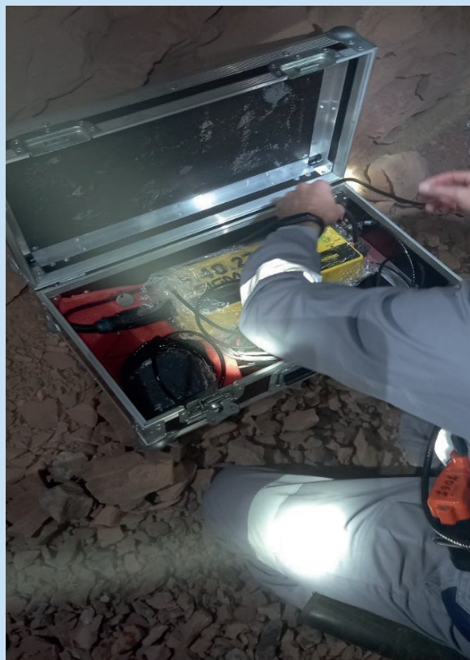
Рис. 2. Установка станции для сейсмомониторинга Sigma 4+.
