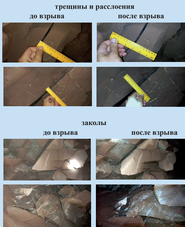
Рис. 1. Результаты визуально-измерительного контроля массива вокруг рассматриваемой выработки до и после производства взрыва.
