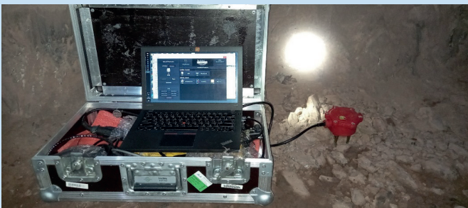
Рис. 4. Установка геофонов на почве выработки и подключение их к сейсмостанции.
