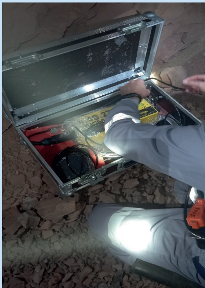
Рис. 2. Установка станции для сейсмомониторинга Sigma 4+.
