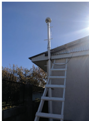
Сурет 2. Базалық GNSS-Қапшағай ауданында орнатылған станция.
