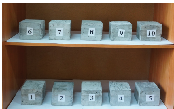
Сурет 1. Бүрікпелбетон үлгілерінің қысу беріктігі бойынша сынақ нәтижелері.
