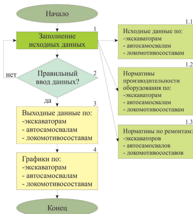
Рис. 2. Укрупненная блок-схема алгоритма функционирования информационно-программного комплекса.
