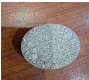
Рис. 1. Неистертая проба, уплотненная в аналитическую кювету.
