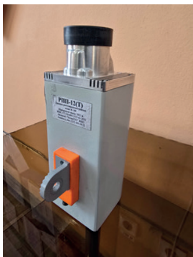
Рис. 3. Портативный рентгенофлуоресцентный анализатор РПП-12Т в процессе измерения.
