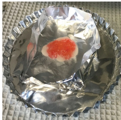
Рис. 3. Внешний вид эмульсионного взрывчатого вещества после тестирования. Сурет 3. Зерттеуден кейінгі эмульсиялық жарылғыш заттың сыртқы пішіні. Figure 3. Physical configuration of the emulsion explosive after experiment.
