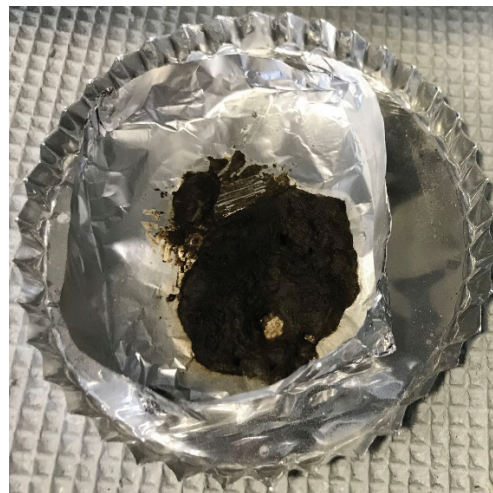
Рис. 7. Внешний вид эмульсионного взрывчатого вещества с образцом пиритсодержащей руды № 2 после тестирования.
