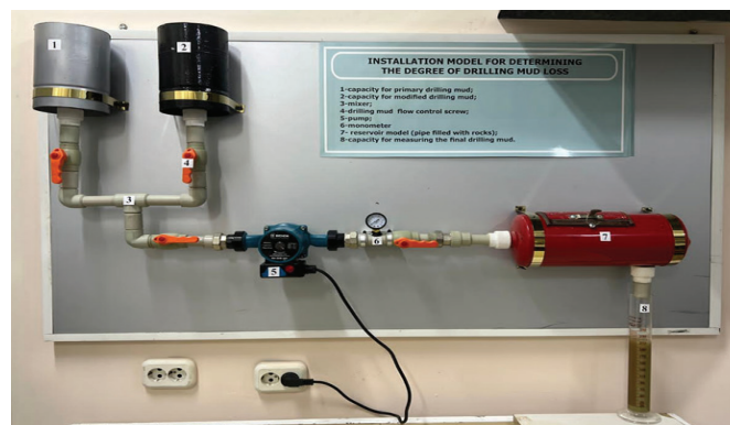
Сурет 3. Бұрғылау ерітіндісінің сіңу дәрежесін анықтау үшін қолданылатын стенд схемасы.
