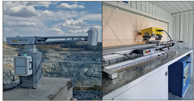
Рис. 2. Радиолокационные системы CHCNAV PS-SAR2000 и Leica IBIS FM-14, установленные на борту карьера.
