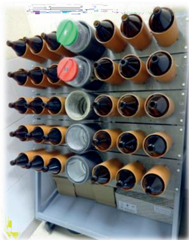
Рис. 1. Лабораторный стенд для проведения исследований по агитационному выщелачиванию. Сурет 1. Үгіттік шаймалау бойынша зерттеулер жүргізуге арналған зертханалық стенд. Figure 1. Laboratory bench for conducting research on agitation leaching.
