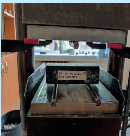
Сурет 2. 40,1 x 40 x 160 мм өлшемді 3 секциялы арқалық пішінді қалып.
