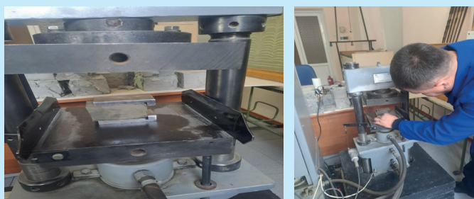
Сурет 6. ИП-100 сынақ пресімен цемент тасын беріктілікке дайындау. Figure 6. Preparation of cement stone for strength testing using the IP-100 testing press. Рис. 6. Подготовка цементного камня к испытанию на прочность с помощью испытательного пресса ИП-100.
