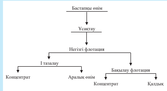
Сурет 4. Зертханалық эксперименттің принципті технологиялық сызбасы. Figure 4. The basic technological scheme of the laboratory experiment.
