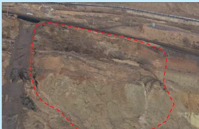
Рис. 1. Снимки Деформации № 1, северо-западный борт с гор. +384 м на гор. +344 м. Сурет 1. № 1 деформацияның суреттері, +384 м гор. +344 м гор. солтүстік-батыс жағынан. Figure 1. Images of Deformation No. 1, north-west side from hor. +384 m to hor. +344 m.
