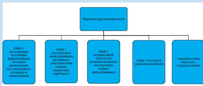
Рис. 1. Варианты переработки молибденового концентрата пирометаллургическим способом.
