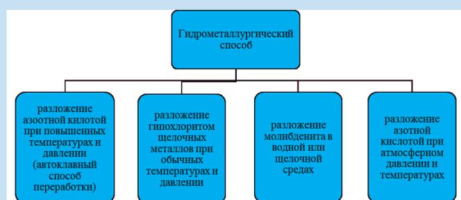
Рис. 2. Варианты переработки молибденового концентрата гидрометаллургическим способом.
