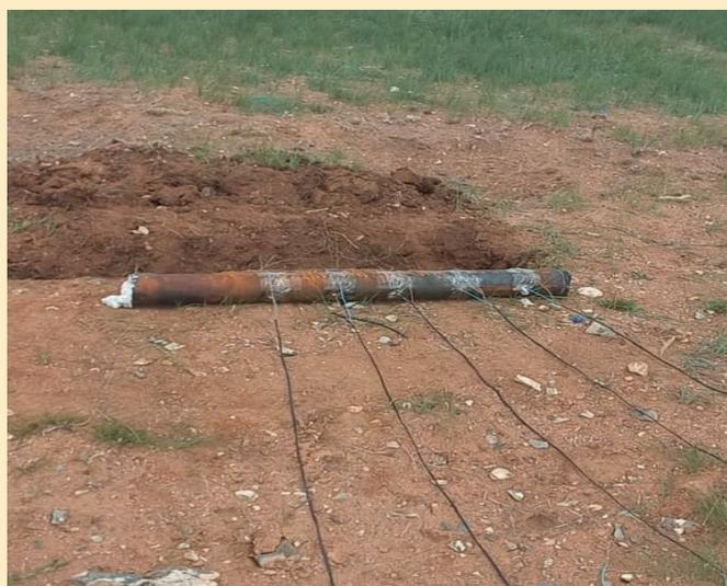
**Рис. 6. Заряд ВВ с подключенными датчиками.
