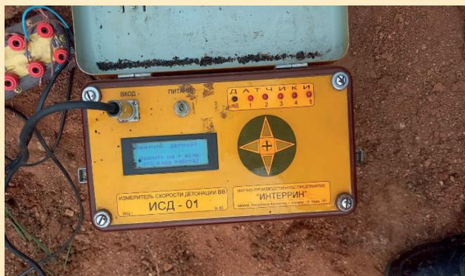
**Рис. 5. Измеритель скорости детонации ИСД-01.
