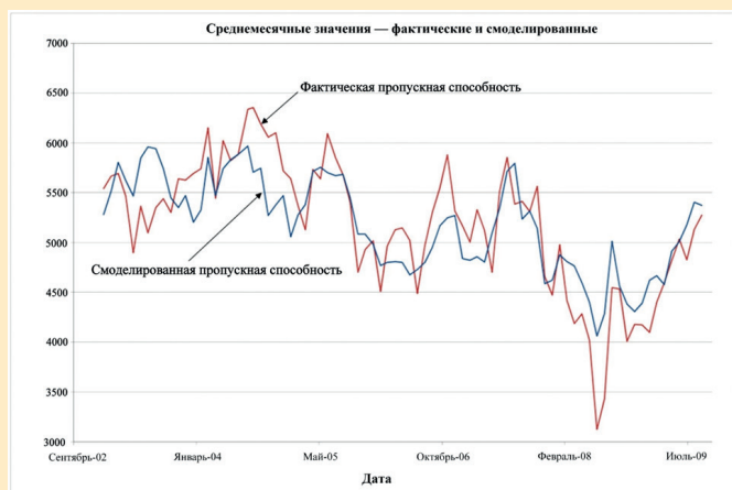
Рис. 5. График сравнения прогнозной модели и фактических данных суточного производства.
