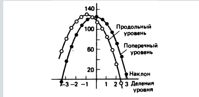
Рис. 4. Зависимость отсчета от наклона (продольный уровень не отъюстирован). 1 деление уровня соответствует 30".
