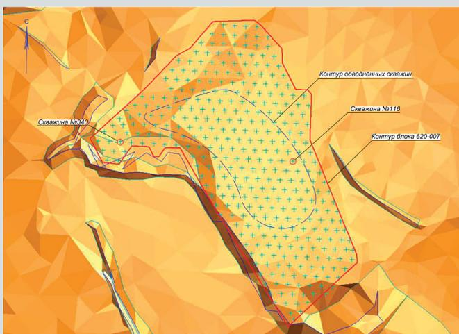
**Рис. 4. Схема блока №620-007 к уточнению границ.**
