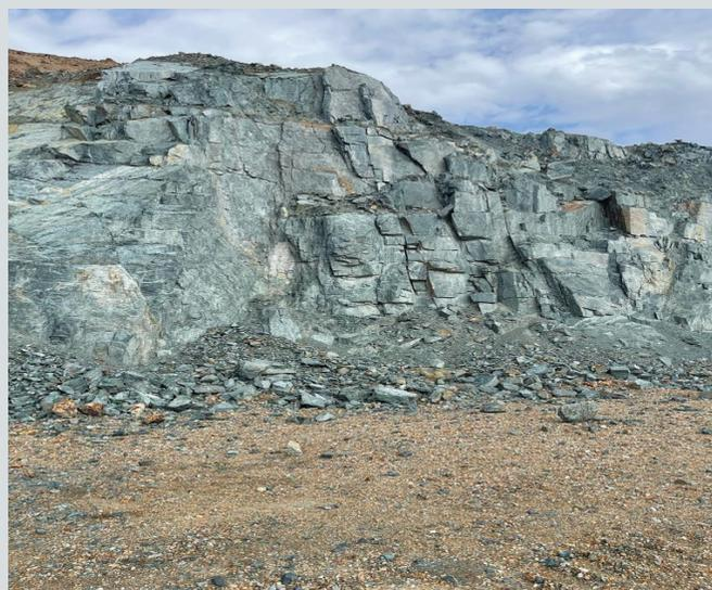
**Рис. 6. Вид на деформированный откос уступа.**
