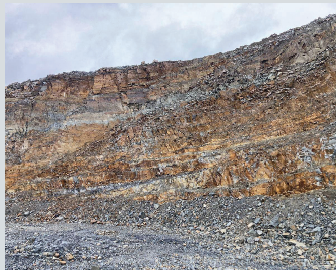
Сурет 1. Шығыс Сарыоба карьеріндегі тау жыныстарының жарықшақтылығы.
