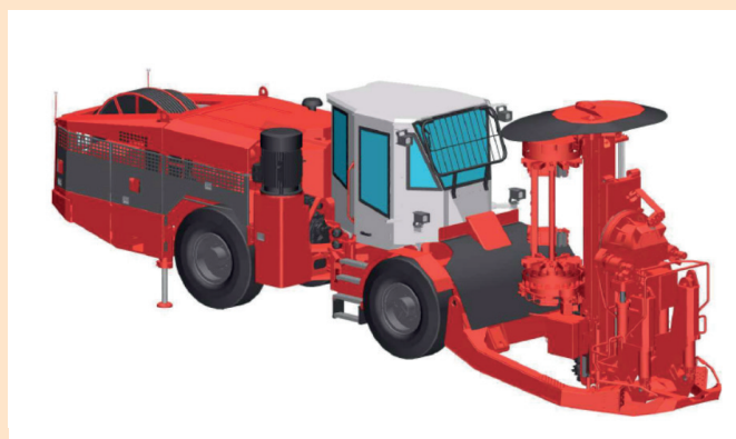
Сурет 2. Sandvik DL420-15 бұрғылау қондырғысы.
