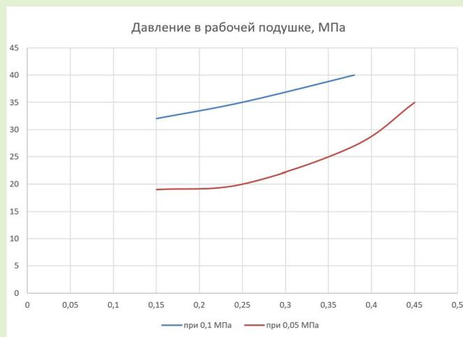
**Рис. 5. График зависимости расхода воздуха от давления в рабочем сильфоне и давления в сильфоне для имитации сопротивления.**
