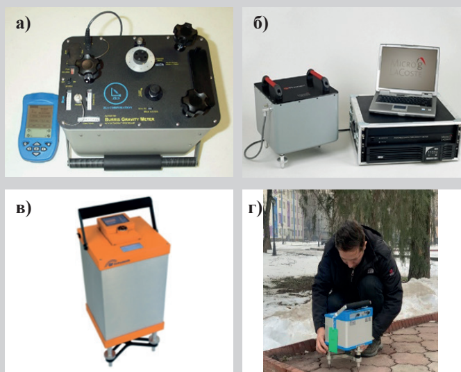
Рис. 8. Современные актуальные гравиметры для измерения относительных значений силы тяжести: а) Burris Gravity Meter; б) гравиметр gPhone X; в) LG-1 GALILEO; г) CG-6 Autograv.
