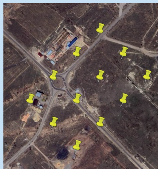
Рис. 4. Выполнение привязки (слева) и план опознаков в районе подработанной территории (справа) [составлено авторами].
