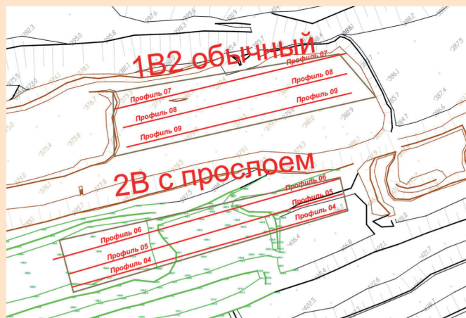
Рис. 4. План участков №2 2В с прослоями и №3 1В2 «Центр» с положением профилей электротомографии. Масштаб 1:100.
