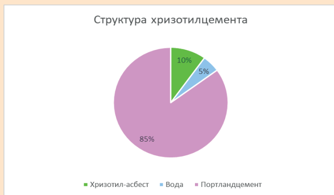
Рис. 3. Средний состав хризотилцемента. Сурет 3. Хризотилцементтің орташа құрамы. Figure 3. Average composition of chrysotile cement.
