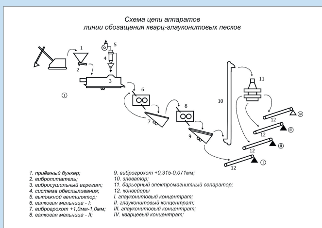
Рис. 9. Схема цепи аппаратов линии обогащения кварц-глауконовых песков.
