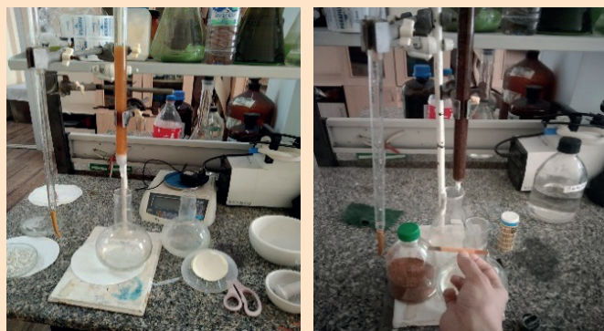
Рис. 3. Удаление анионов и катионов в растворе акриламида.
