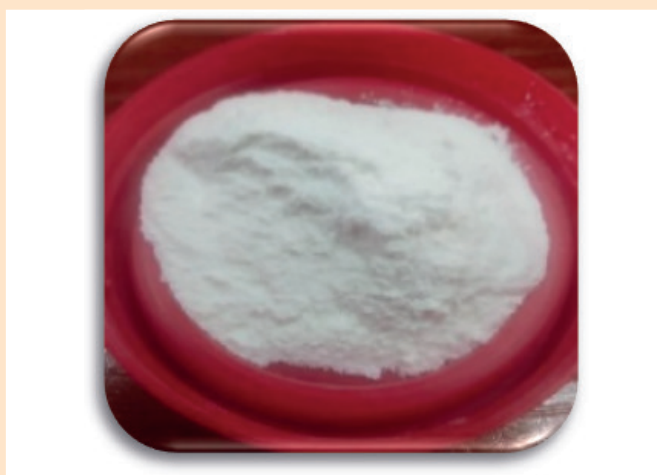
Рис. 6. Национальный буровой реагент типа ПАА-СА. Сурет 6. ПАА-СА типті Ұлттық бұрғылау реагенті. Figure 6. National drilling reagent of the PAA-SA type.
