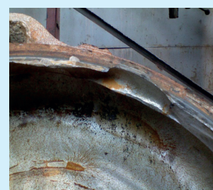
Рис. 3. Износ корпуса грунтового насоса 8Гр-8. Сурет 3. 8Гр-8 топырақ сорғысы корпусының тозуы.
