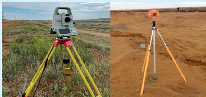
**Рис. 3. Электронный тахеометр с оптическим отражателем.**
