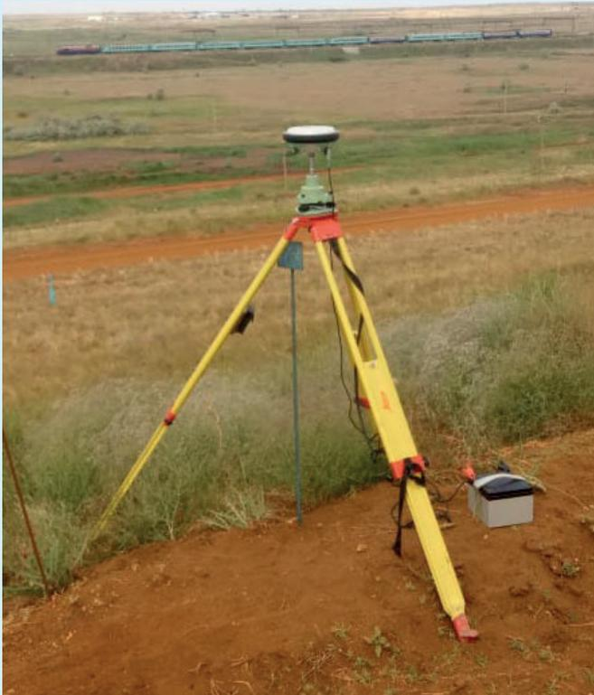
**Рис. 5. Базовая GPS станция на опорной точке.**
