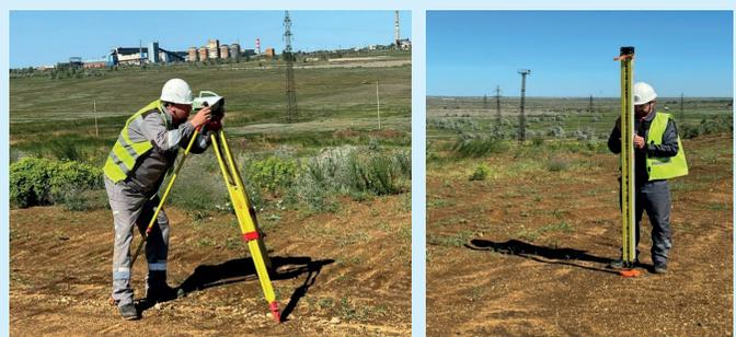
**Рис. 6. Нивелирование цифровым нивелиром и инварной рейкой.**
