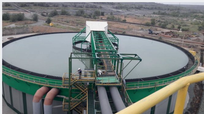
Рис. 2. Высокоскоростной сгуститель HRT-62 на ЮГОКа.
