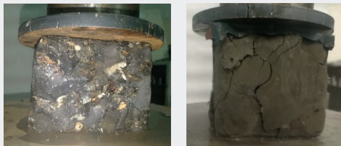
Рис. 3. Испытания образца льдопородной закладки без добавок (а) и с добавлением сухой смеси Rock Support (0,6 л воды на 1 кг сухой смеси) (б) на предел прочности на одноосное сжатие.
