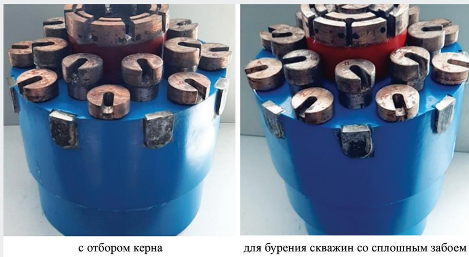
**Рис. 2. Алмазные бурильные головки с гидроструйным эффектом разрушения пород диаметром 215,9 мм.
