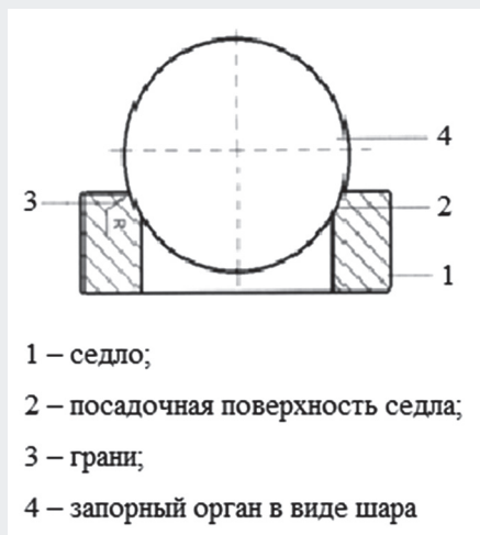
Рис. 5. Шаровой клапан углубленной посадки. Сурет 5. Терен қондырылған шар клапаны. Figure 5. Deep seat ball valve.
