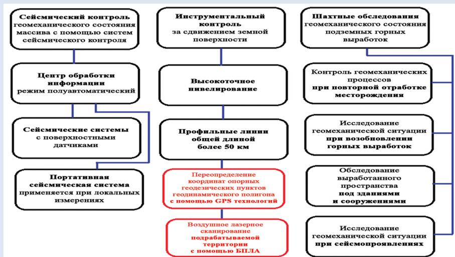
Рис. 1. Структура проведения комплексного мониторинга на Жезказганском месторождении.
