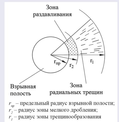
Рис. 1. Структура зон разрушения вокруг взрывной полости.
