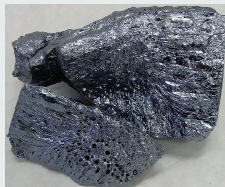
Рис. 2. Слиток очищенного кремния, полученного после процесса шлакового рафинирования.
