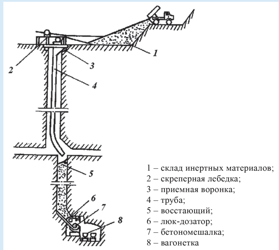
Рис. 1. Технология приготовления закладки на подземной участковой установке.
