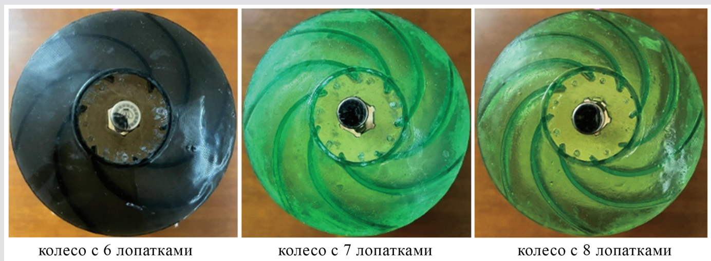
Рис. 2. Модели колес насоса, напечатанного технологией SLA. Сурет 2. SLA технологиясымен басылған сорғы доңғалақтарының модельдері. Figure 2. Models of pump wheels printed with SLA technology.
