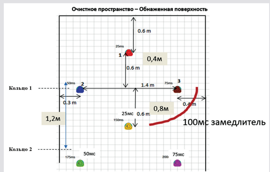
Рис. 3. Схема бурения маломощных рудных тел.
