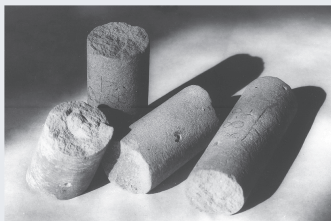
Рис. 1. Керны, выбуренные из закладочного массива.
