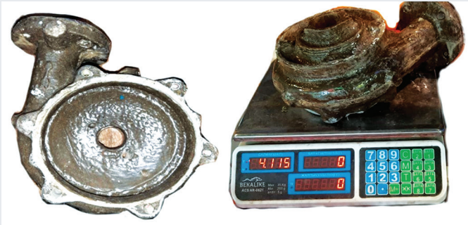
Рис. 1. Корпус центробежного насоса из фибробетона и процесс взвешивания.
