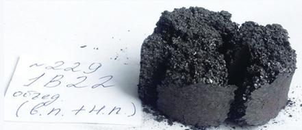
**Рис. 2. Вид пластометрического полукокса из угля пласта 1B22.**
