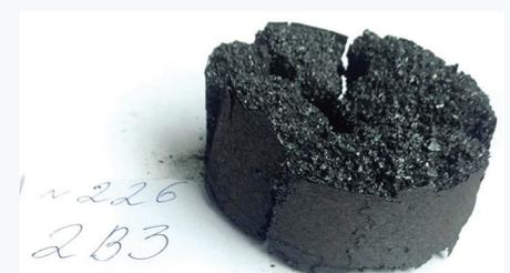
**Рис. 5. Вид пластометрического полукокса из угля пласта 2B3.**
