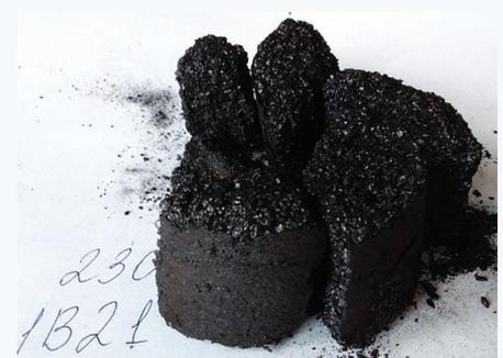
**Рис. 1.** Вид пластометрического полукокса из угля пласта 1В21. Сурет 1. 1В21 көмір қабатынан жасалған пластометриялық жартылай кокстың түрі.
