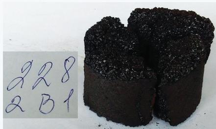
**Рис. 3. Вид пластометрического полукокса из угля пласта 2B1.**
