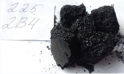
**Рис. 6. Вид пластометрического полукокса из угля пласта 2В4. Сурет 6. Пластометриялық жартылай окстың қабат көмірінен жасалған түрі 2В4. Figure 6. Type of plastometric semi-coke from coal formation 2V4.**
