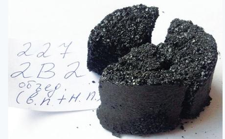
**Рис. 4. Вид пластометрического полукокса из угля пласта 2B2.**
