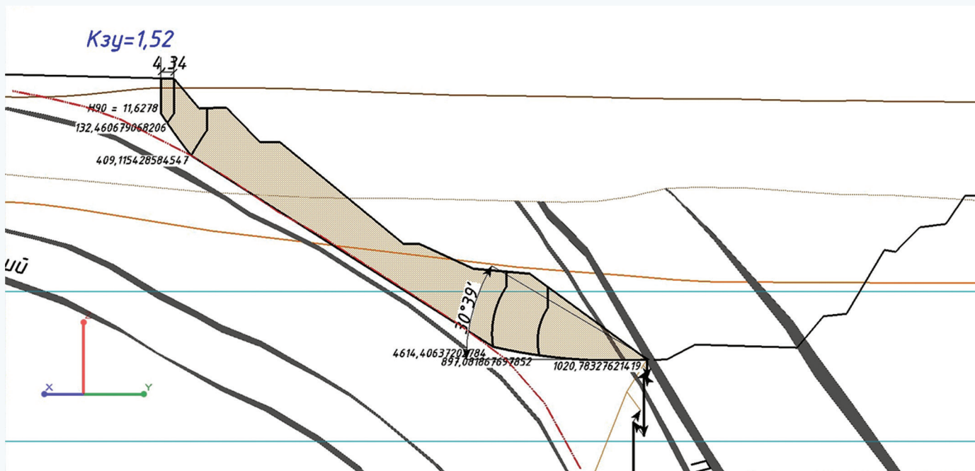
Рис. 2. Расчет коэффициента устойчивости с помощью цифровой геолого-маркшейдерской модели. Сурет 2. Сандық геологиялық маркшейдерлік моделін қолдана отырып тұрақтылық коэффициентін есептеу. Figure 2. Calculation of the stability coefficient using the digital geological surveying model.
