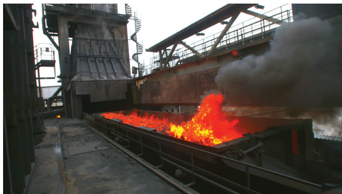
Раскаленный кокс коксохимического производства в Окселесунде. Для футеровки оборудования применяется Hardox® HiAce
