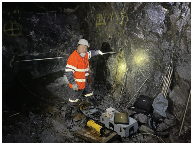
Рис. 3. Фотографии оборудования для замера природного поля напряжений на замерной станции рудника Суздальский.
