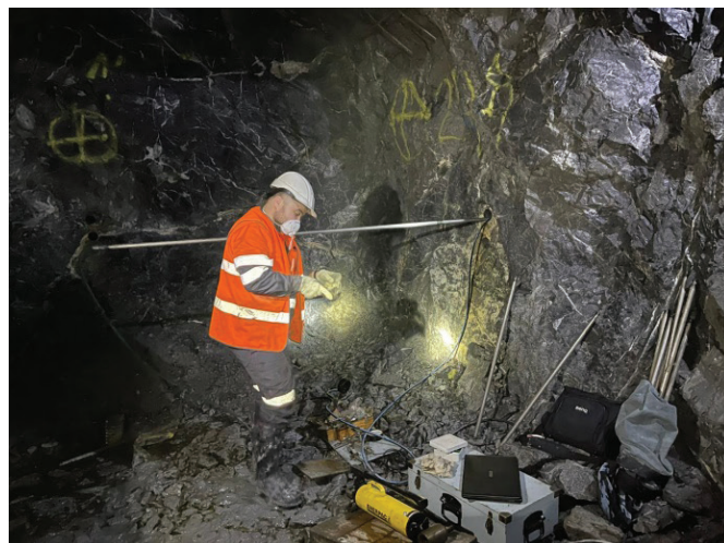
Рис. 3. Фотографии оборудования для замера природного поля напряжений на замерной станции рудника Суздальский.
