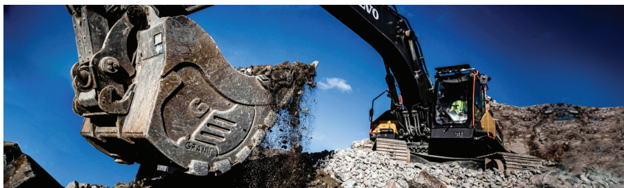
Ковш для тяжелых карьерных работ, изготовленный с применением износостойкой стали Hardox® 500 Tuf
