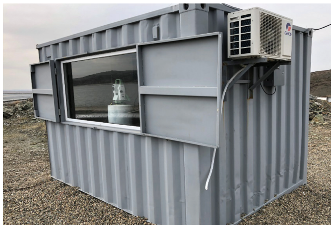
Рис. 2. Автоматизированная система с мониторинговой кабиной и ПО GeoMos.
