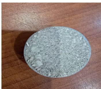
Рис. 1. Неистертая проба, уплотненная в аналитическую кювету.
