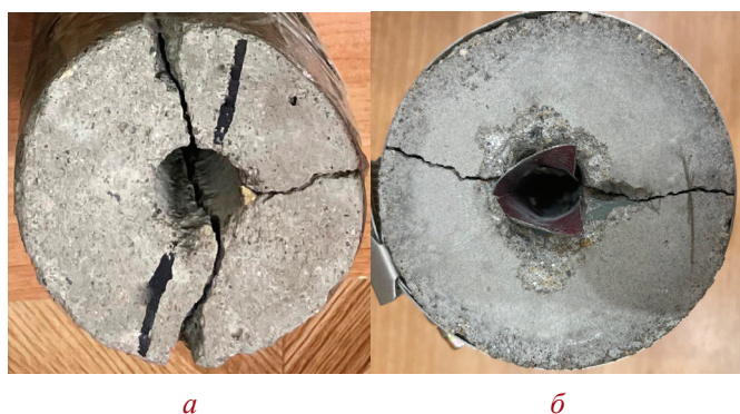
Рис. 3. а – вид торцевой поверхности бетонного образца после взрыва, б – вид торцевой поверхности обжатого металлическими хомутами бетонного образца после взрыва.
