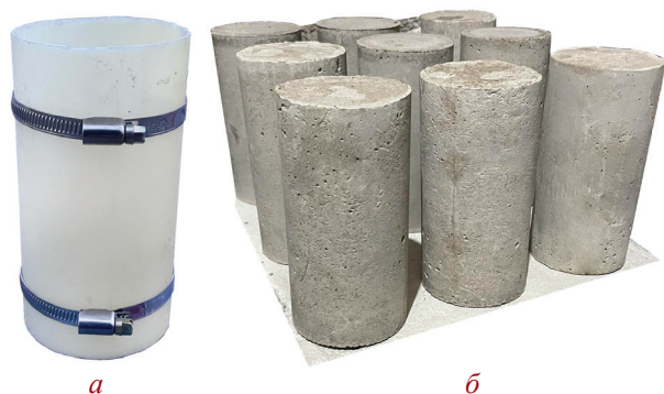
Рис. 1. а – разборная пластиковая форма, б – цилиндрические бетонные образцы.
