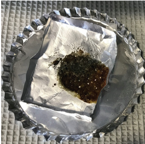
Рис. 5. Внешний вид эмульсионного взрывчатого вещества с образцом пиритсодержащей руды № 1 после тестирования.
