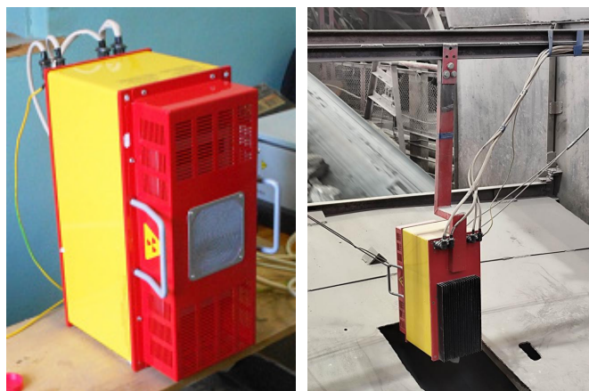
Рис. 1. Рудоконтролирующая станция: общий вид и установка на Жезказганской обогатительной фабрике № 2.
