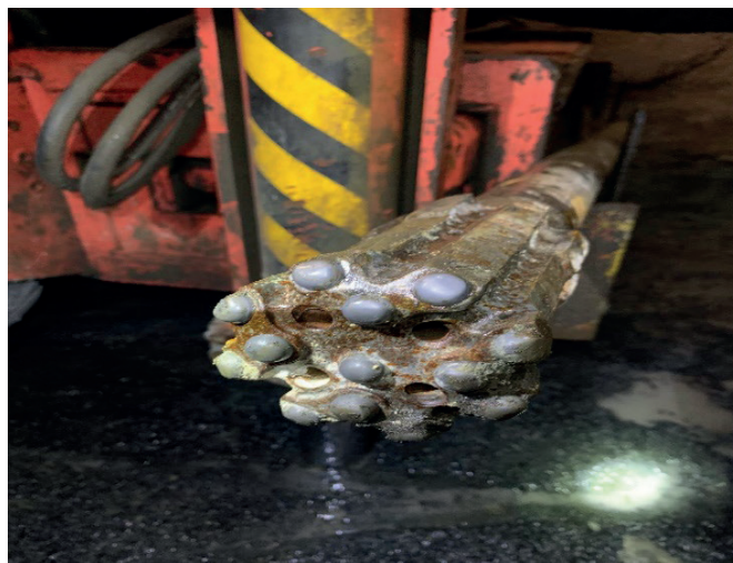
Рис. 2. Состояние долота в начальный и конечный момент эксплуатационного срока. Сурет 2. Қашаудың пайдалану мерзімінің бастапқы және соңғы сәтіндегі күйі. Figure 2. Condition of drill bit at commissioning vs. end-of-service stages.
