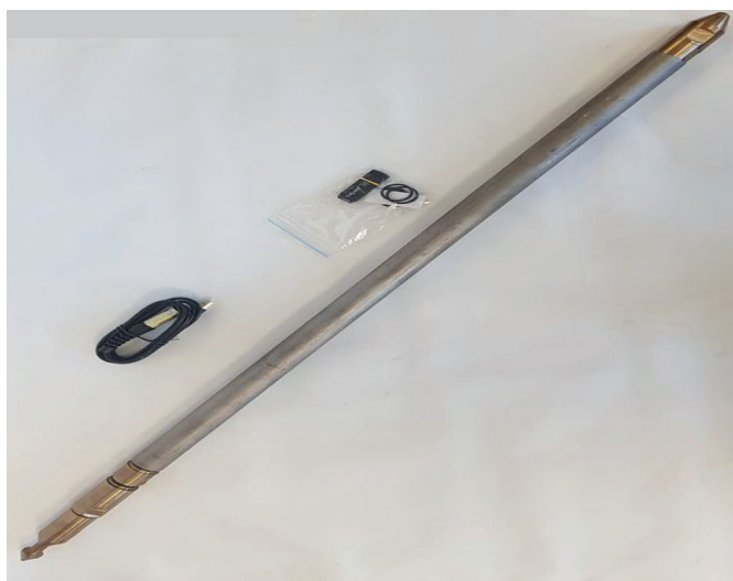
Рис. 1. Скважинный инклинометр АИ-30:
