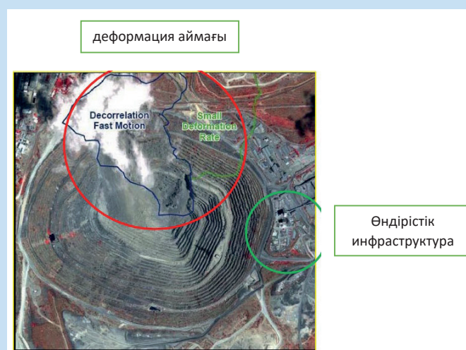
Сурет 3. Палабора кенішінің ашық қазу әдісінен жерасты қазу әдісіне көшу үлгісі.
